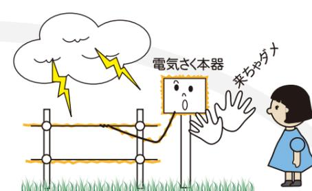
・本器が異なる、隣接する電気さくを同時に触れないよう、絶縁された遮へい物を置いてください。また、その遮へい物沿いの距離が2m以上となるようにしてください。★
