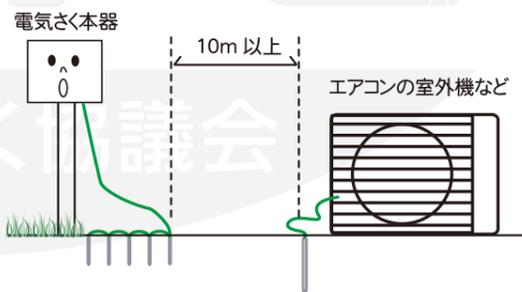
・商用電源(AC100V)を使用する場合、図のように接続し次の①②を厳守してください。
