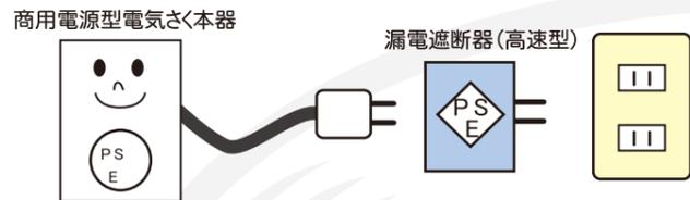
・水道管やガス管をアースとして使用しないでください。同管にショック電流が流れたり、管が電気さくのパルス電気で錆を呼び、穴をあけることがあります。★
