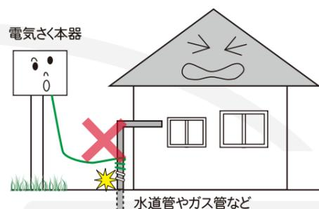
・使用する電気さく本器が直流(DC)12V型であってACアダプタを使用する場合、図のように接続し次の①②を厳守してください。
