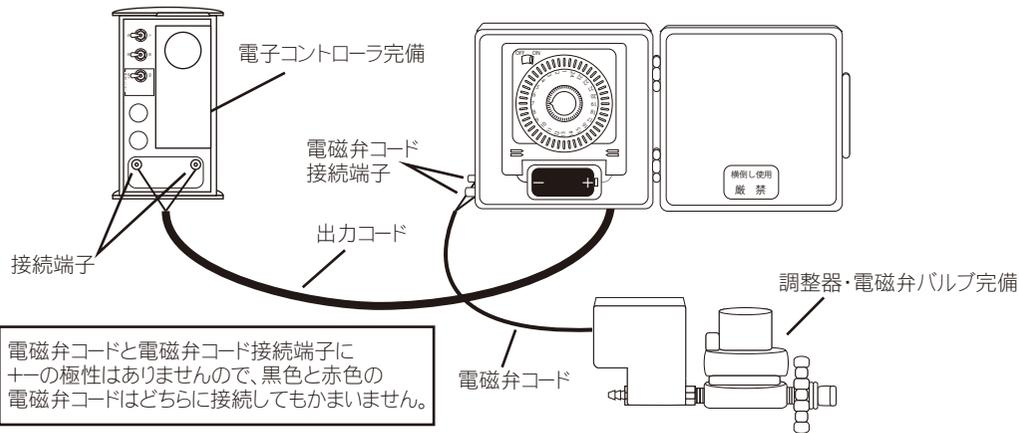
電磁弁コードと電磁弁コード接続端子に+-の極性はありませんので、黒色と赤色の電磁弁コードはどちらに接続してもかまいません。
