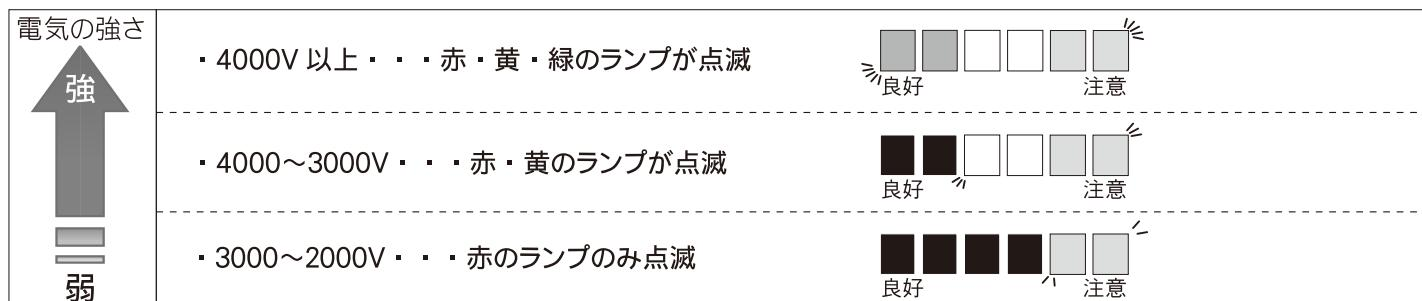
レベルメーターの表示は目安です。正確な電圧測定は本器からもっとも遠いさく線をタイガー純正テスターにて測定してください。
