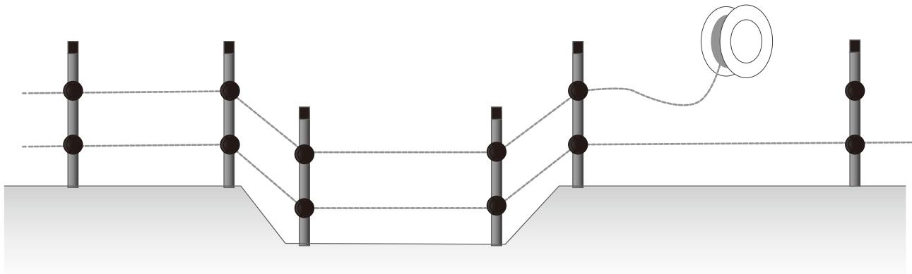
⑤およそ 100 ~ 200m 間隔で、上下のさく線を結ぶ「渡り線」を取り付けます
