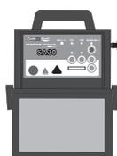
(5) 制御部と電池ケースを合体させてケースフックで固定する
