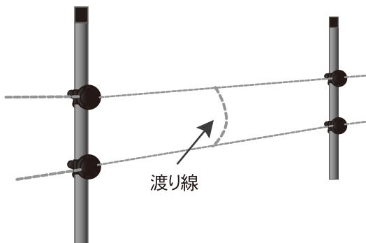
「渡り線」は断線の際、バイパスの役割をするだけでなく、さく線の電圧を安定させます
