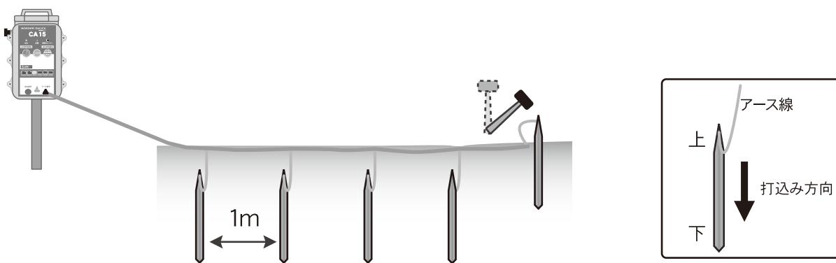
④出力コードをさく線に絡めてしっかりと巻きつけます 必ずアースが確実に接続されていることを確認してください
